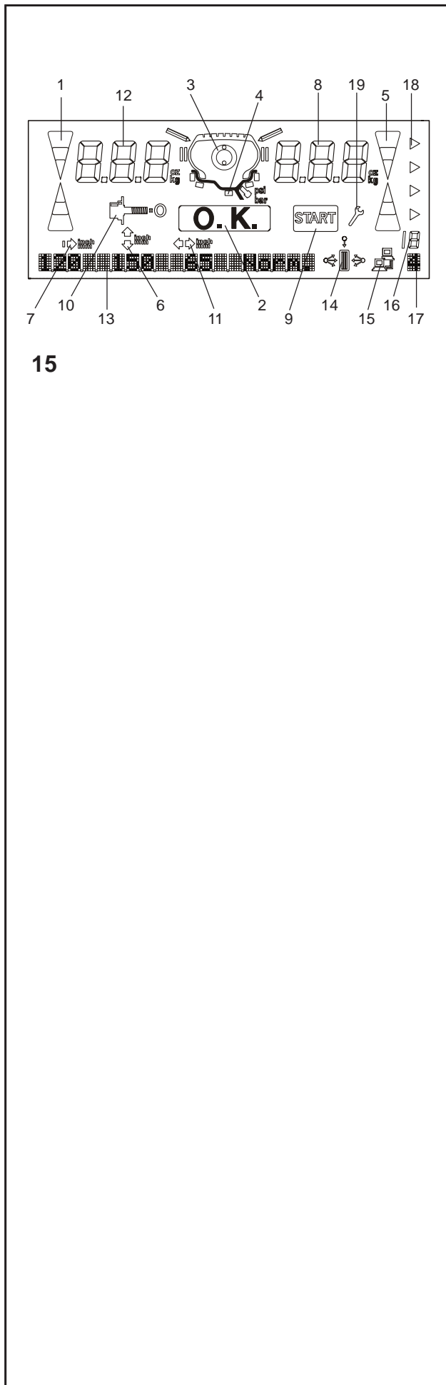
Fig. 15 Panel indicador - visualizaciones y selecciones del operador para actividades distintas
